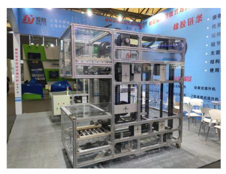
z型提升机优点: 1. 低破碎,物料完整性好□z型提升机采用流入式进料,非传统挖取进料,料斗运行平稳可靠,全程物料破碎率低,完整性较好。2. 组成形式多样,布置灵活,占地空间小□z型提升机本身输送轨迹是水平-垂直-水平输送,可根据客户现场进行测量设计方案,箱体紧贴地面和料仓边缘布置,也可多连续转弯梯形设计,减少不必要的空间占用,合理利用有的厂房空间。3. 环保节能□z型提升机采用封闭机壳设计,避免设备运行过程中产生的粉尘飞扬情况,符合环保的要求。另外z型提升客户根据客户生产工艺需求,定制多个下料口,多个下料口依次进行下料,多个进料口,满足多种物料混合提升的需求;做到一台z型提升机设备,满足多仓供料的需求,节约客户对设备的采购成本□z型斗式提升机可以实现多点下料,下料口数量和位置,可根据客户实际需求来定。南通C型连续式提升机费用
